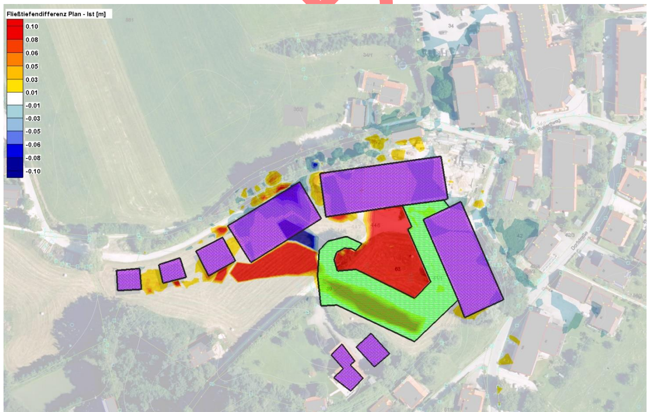
Abbildung 5.7: Detailausschnitt Hotelanlage: Differenzen maximale Fließtiefe (Planungszustand mit Aus- gleichsmaßnahme – Ist-Zustand)
