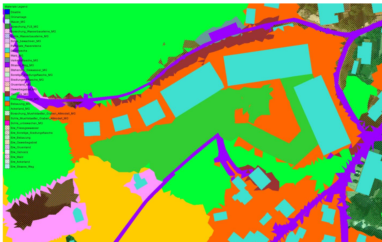
Abbildung 4.4: Ausschnitt Abflussmodell Planungszustand, Hotelanlage – Rauheitsbelegung
