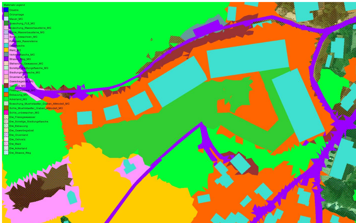
Abbildung 4.4: Ausschnitt Abflussmodell Planungszustand, Hotelanlage – Rauheitsbelegung
