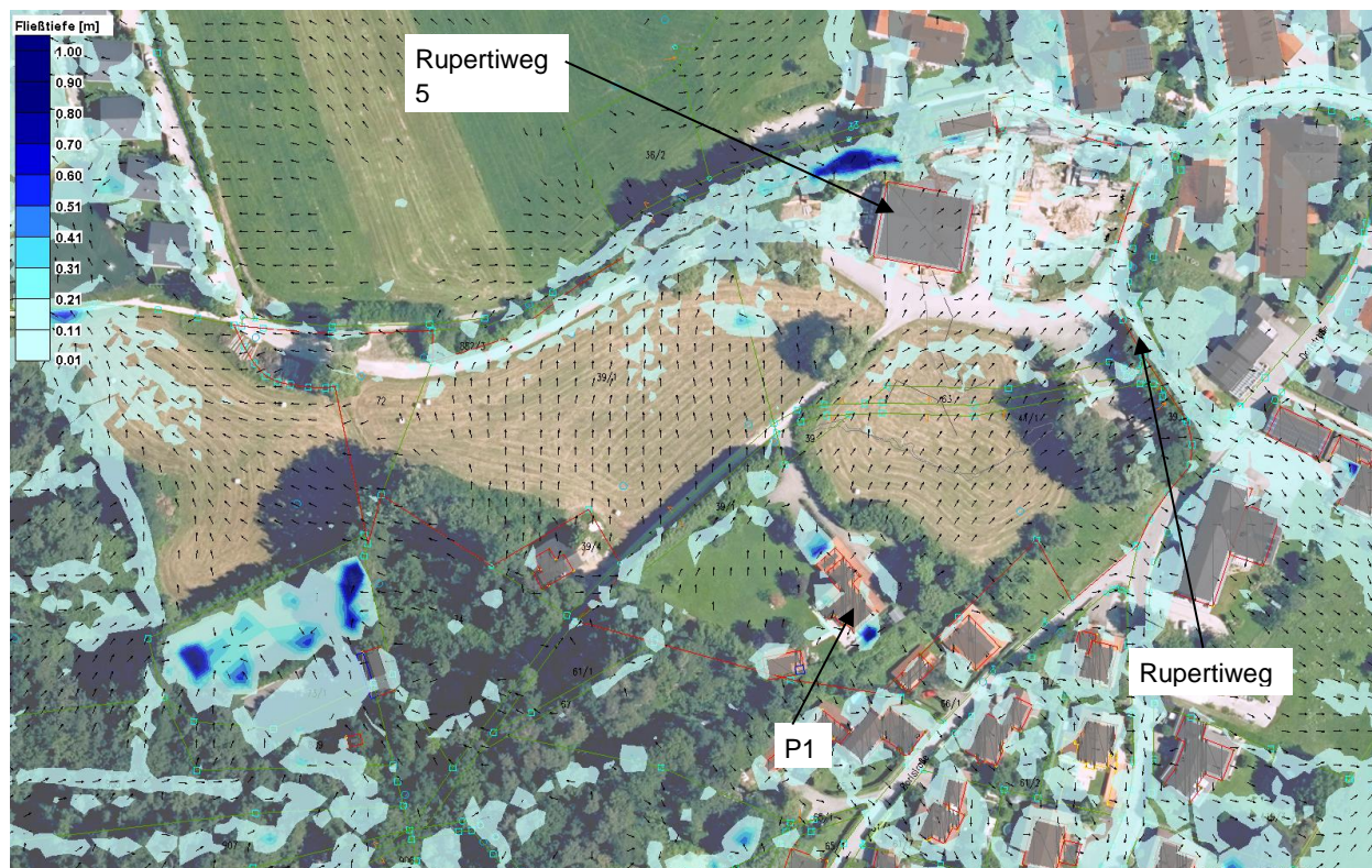
Abbildung 3.7: Detailausschnitt Bereich Hotelanlage: Maximale Fließtiefen und Strömungsrichtungen; Ist-Zustand; HN_{100}
