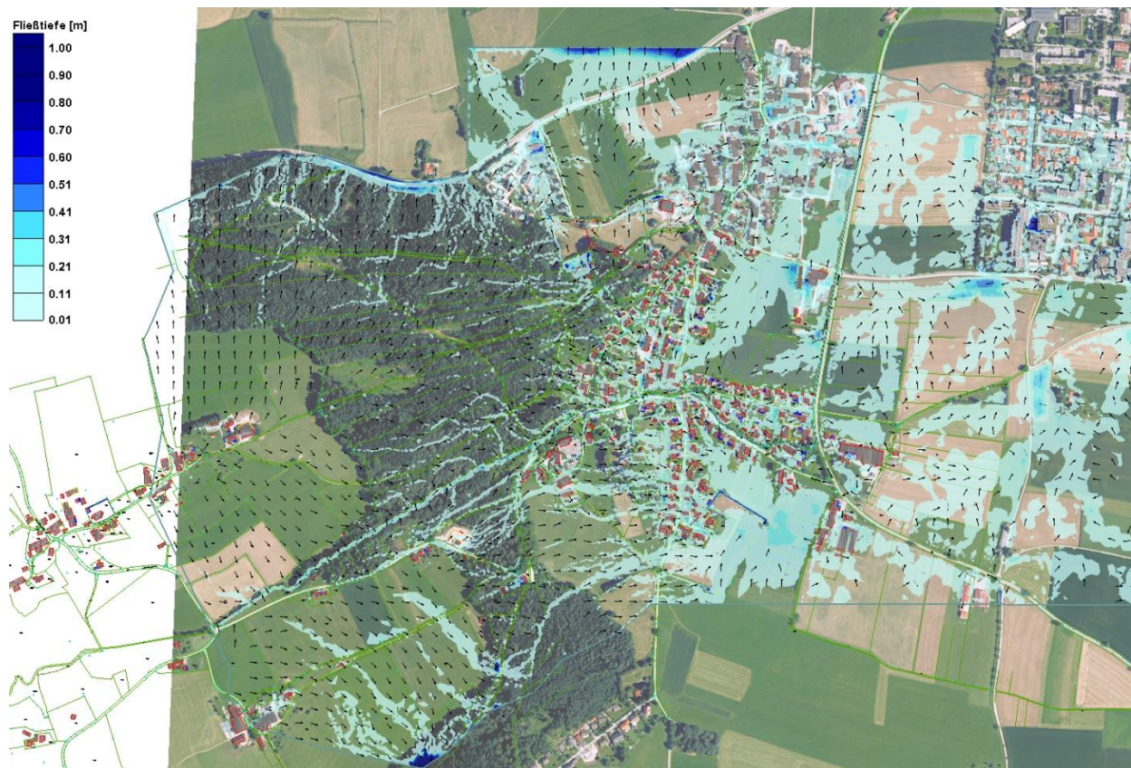
Abbildung 3.5: Übersicht: Maximale Fließtiefen und Strömungsrichtungen; Ist-Zustand; HN_{100}
