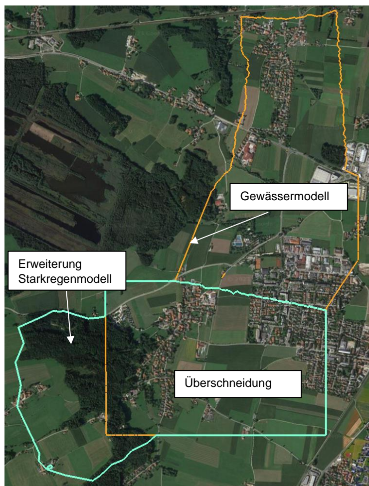
Abbildung 3.1: Umgriff 2D-Abflussmodell zur Starkregenbetrachtung (blau) und zur Untersuchung des Gewässerhochwassers Mühlstätter Graben (orange)
