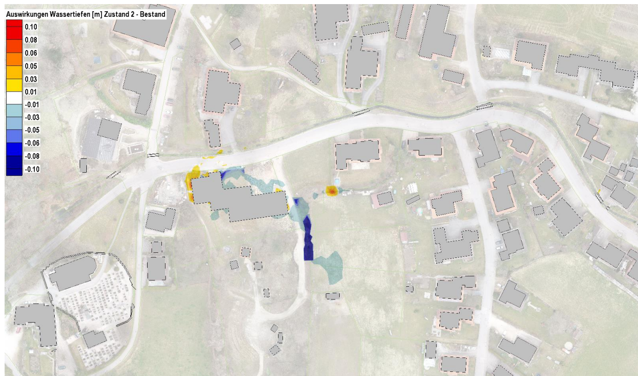
Abbildung 8.5: Maximale Auswirkungen Fließtiefen HQ_{100\text{ WB}} Ist-Zustand mit gültigem Baurecht / Ist-Zustand
