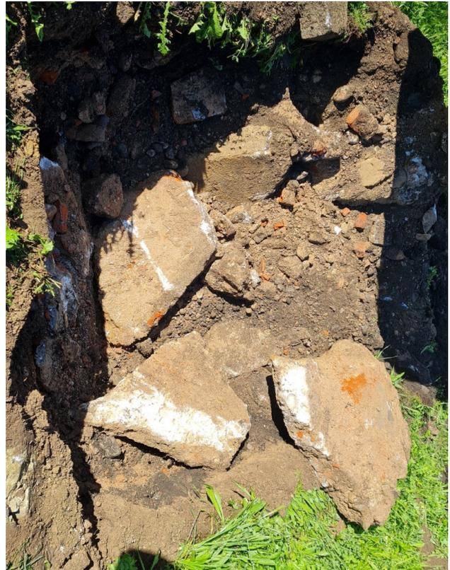
Die Auffüllung ist auf Grund ihrer Zusammensetzung als ein nicht tragfähiger Boden einzustufen. Es muss mit Bodenverunreinigungen gerechnet werden. Die Auffüllung ist getrennt auszuheben, zwischen zu lagern und entsprechen der LAGA PN 98 zu beproben. Die Entsorgung der Auffüllung erfolgt dann entsprechend der Analysenergebnisse. Es wird empfohlen den Aushub mit einer Aushubüberwachung durchzuführen, die die einzelnen Fraktionen sortieren kann.
