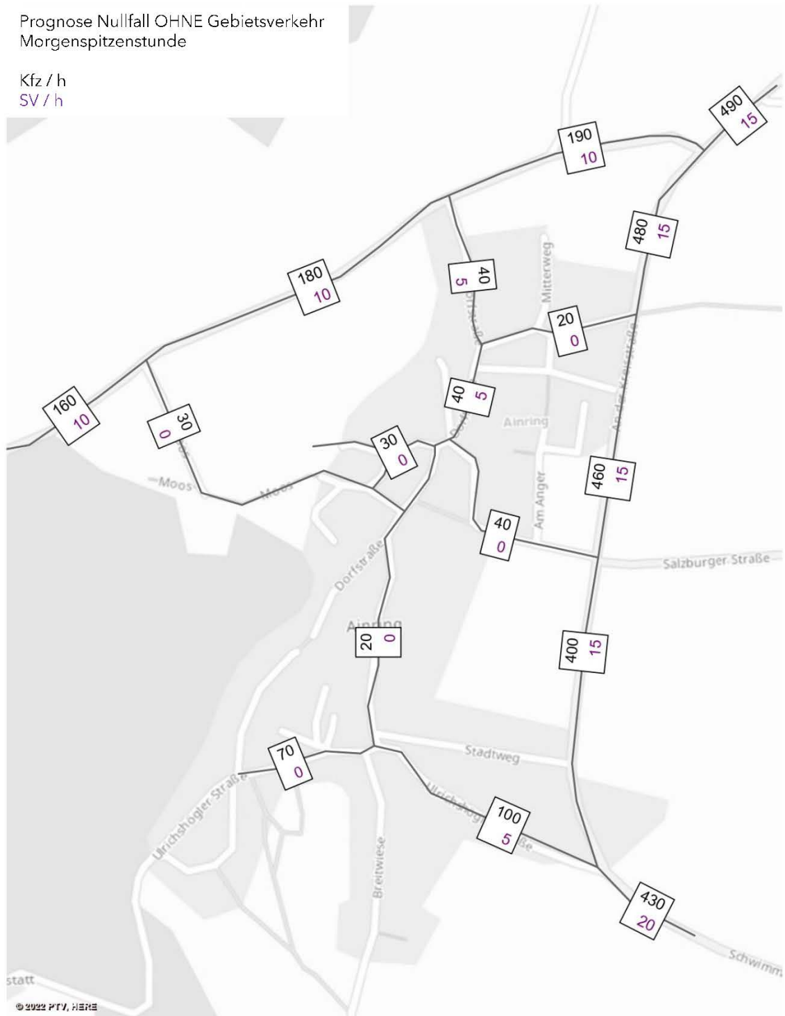
Abbildung 11: Verkehrsmengengerüst Prognose Nullfall OHNE Gebietsverkehr, Morgenspitzenstunde (Kfz und Schwerverkehr )
