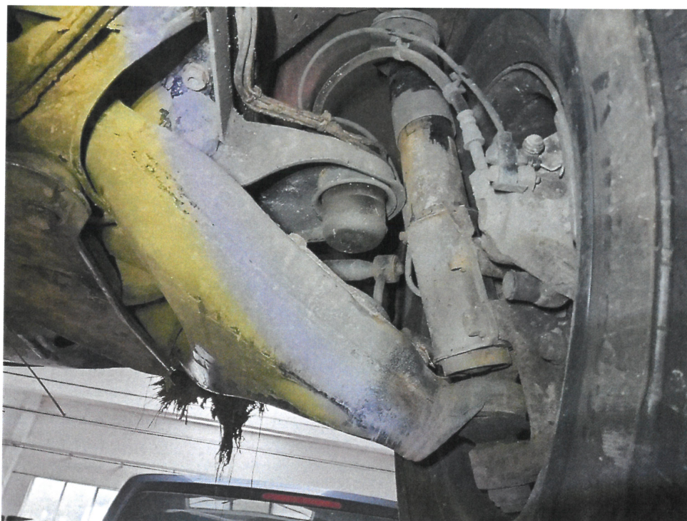
Bild 16 : Achse rechts deformiert
