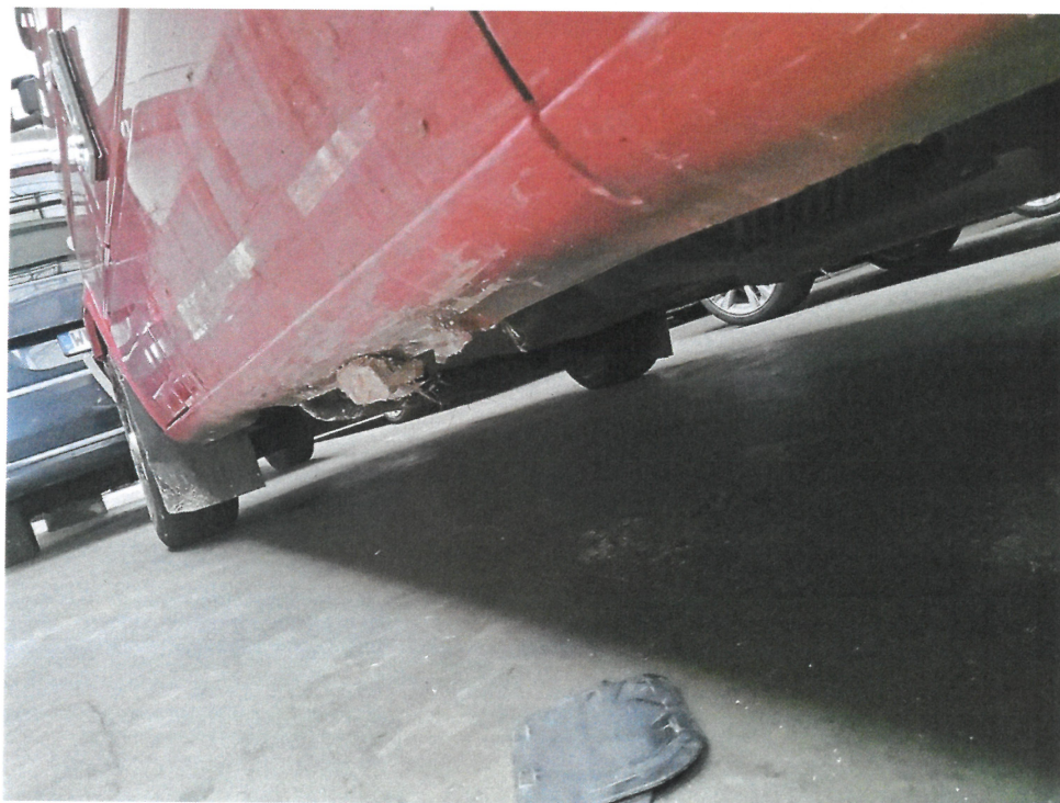
Bild 14 : Unterboden gedrückt
