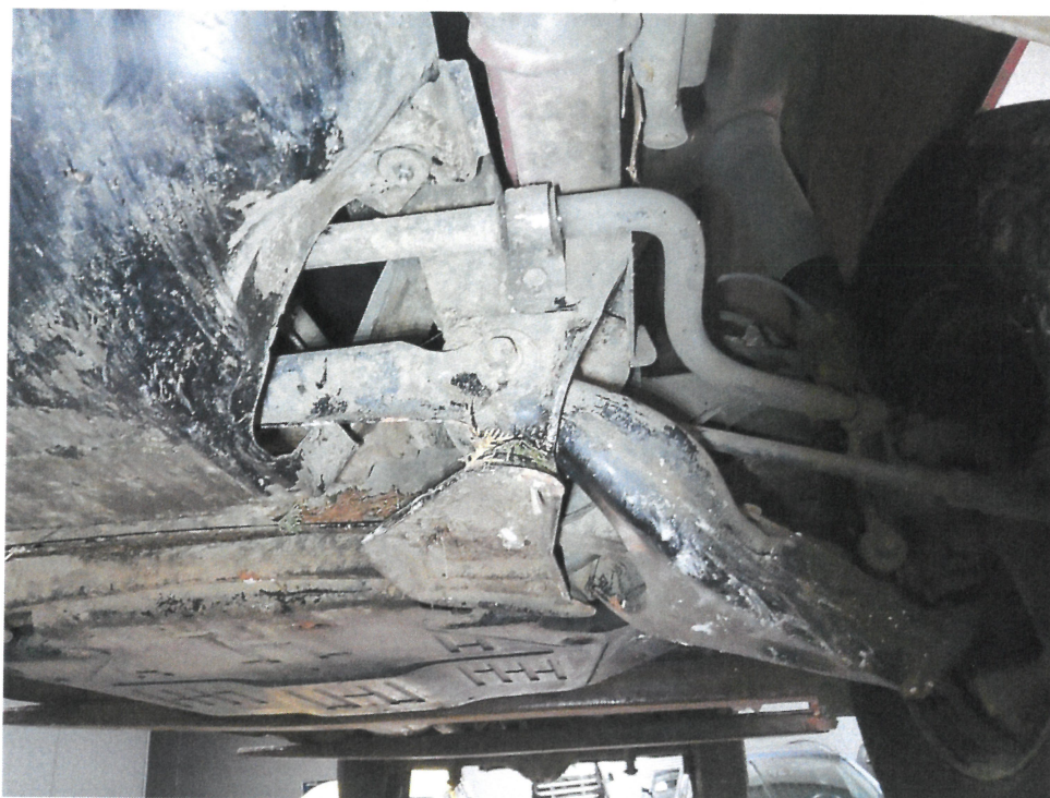
Bild 18 : Verkleidungen abgebrochen
