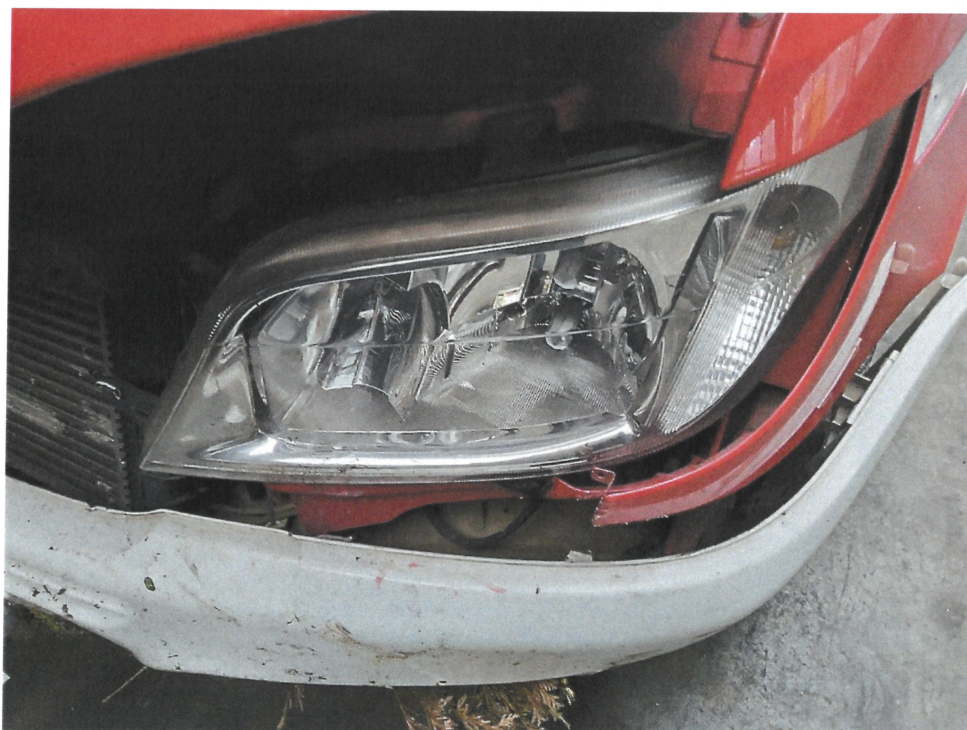
Bild 15 : Scheinwerfer links abgebrochen
