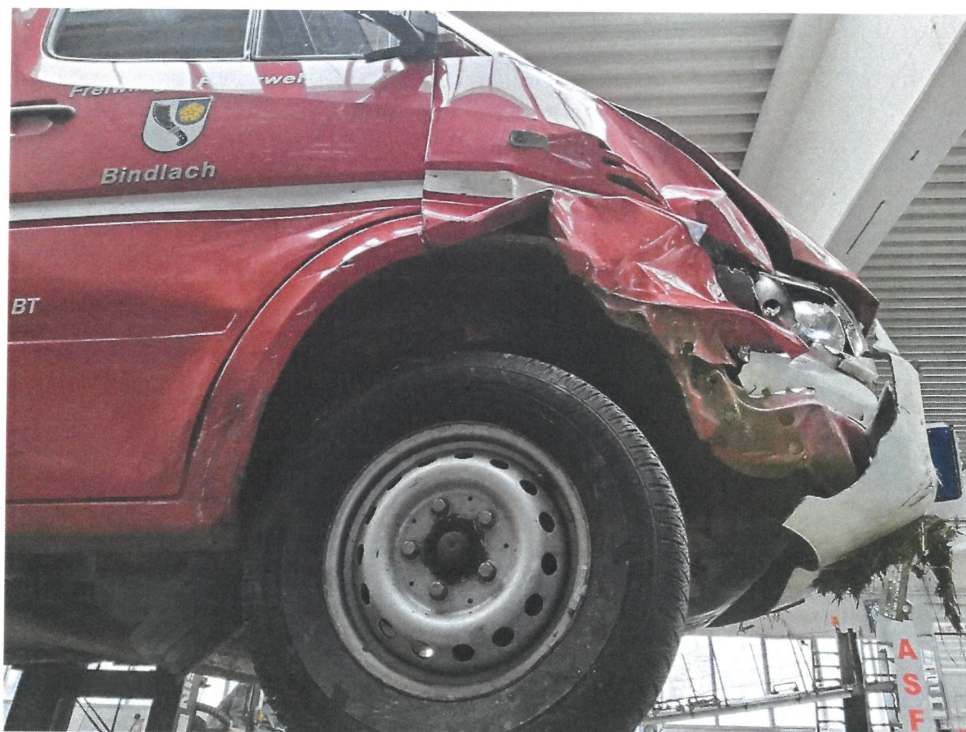
Bild 20 : Achse rechts deformiert
