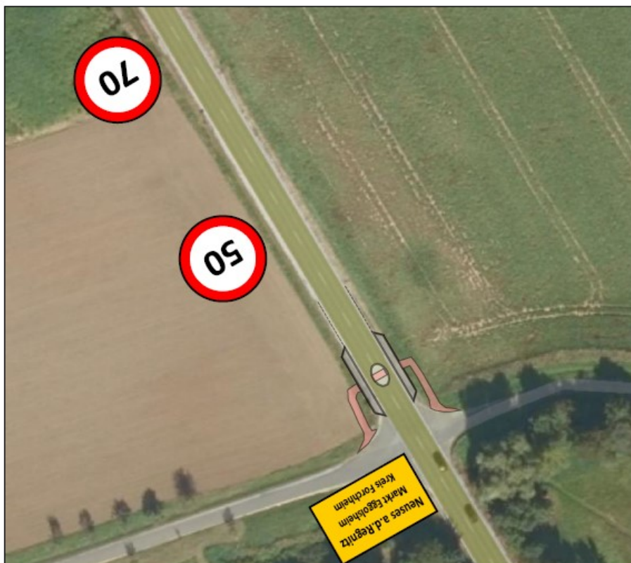
Abbildung 5: Schematische Darstellung eines "Geschwindigkeitstrichters" am nördlichen Ortseingang von Neuses a.d.Regnitz
