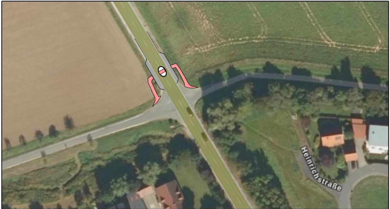
Abbildung 2: Luftbild-Skizze mit einer Querungshilfe an der Staatsstraße St 2244 am nördlichen Ortseingang von Neuses a.d. Reanitz
