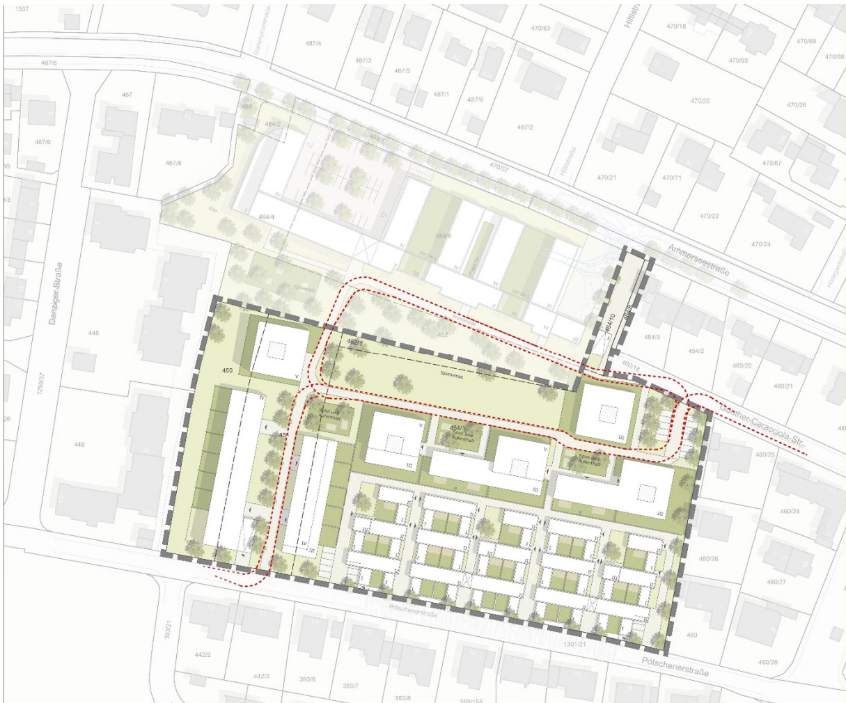
Abb. 20: Erschließung für Müll- und Rettungsfahrzeuge mit notwendigen Radien (rot gestrichelt)
