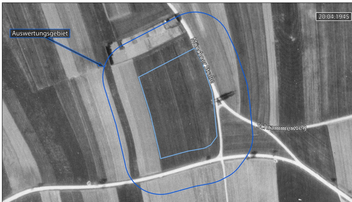
Abb. 3: Das Projektgebiet (hellblau markiert) mit dem um 50 m gepufferten Auswertungsgebiet (dunkelblau) am 20.04.1945 (Flug-Nr. 31-5004, #2055, Ausgangsmaßstab ca. 1 : 10.000).
