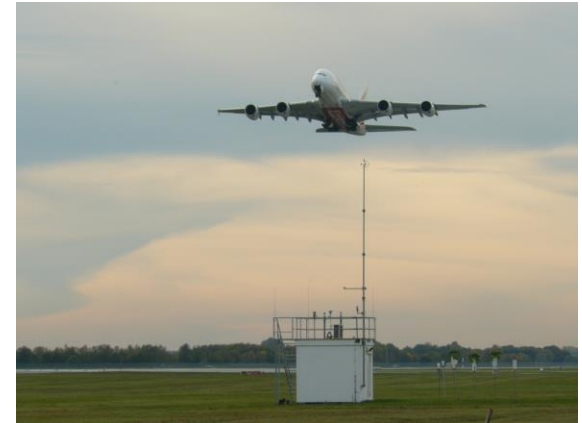
Luftgütemessungen (LHY7) nahe der Emissionsquelle
