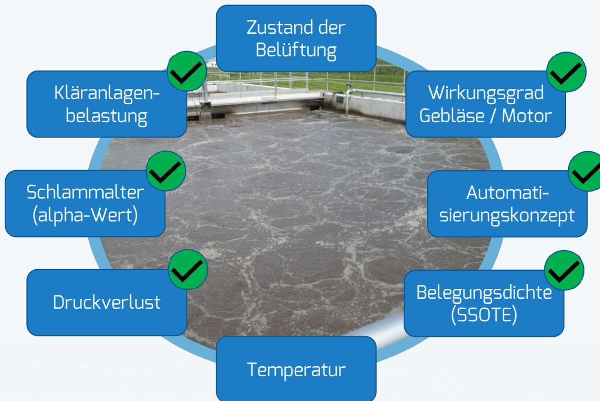
Mit der dynamischen Simulation können die verschiedenen Einflüsse auf den Energiebedarf simuliert und prognostiziert werden.
