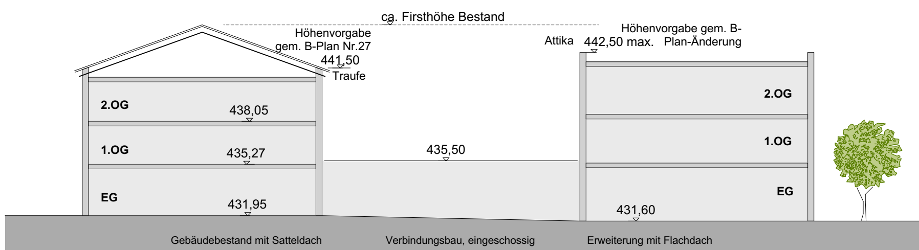
Systemschnitt - Gebäudebestand und geplante Bebauung, o. M.
