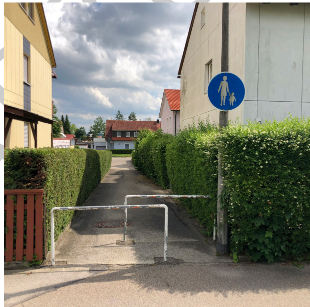
Abbildung 18: Beispiel Schwächen: fehlende Durchlässigkeit für den Radverkehr durch bauliche Unzulänglichkeiten; Beispiel fehlende Freigabe des Fußwegs für den Radverkehr und nicht richtlinienkonforme Umlaufsperr am Bayernring
