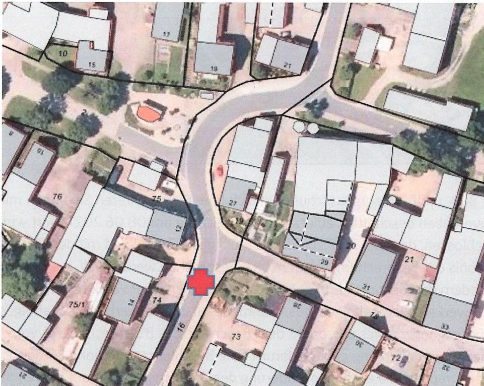
Fahrbahnteiler (mind. 1,75 m Breite). Die Straße wird in diesem Bereich verbreitert. Der Gehweg wird dadurch verkleinert. Der Gehweg, der dann für die Straße verwendet wird, ist für die Belastung der LKW eigentlich nicht ausgelegt.
