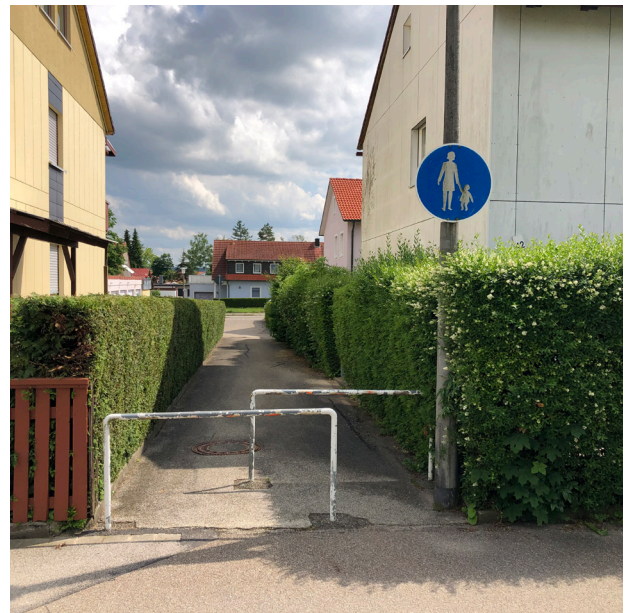
Abbildung 19: Beispiel Schwächen: fehlende Freigabe des Fußwegs für den Radverkehr und nicht richtlinienkonforme Umlaufsperrn (Bayernring)
