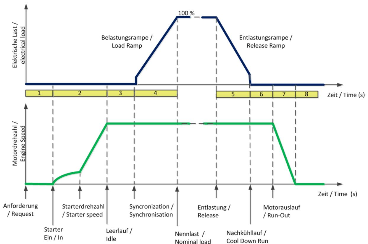
Nachfolgende Zeitangaben der einzelnen Startabschnitte bis zur Nominallast sind **Richtwerte** für einen vollautomatischen Start unter vorgewärmten Bedingungen. Ausschließlich die Gesamtstartzeit wird dabei
