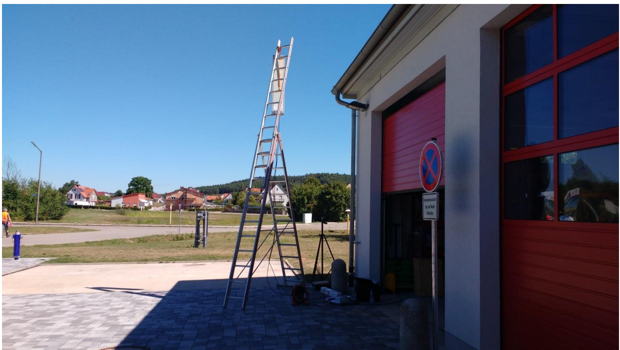
Abbildung 6: B) Standort IZAR RDC Premium mit Richtantenne X-Pol (Höhe 4 m)
