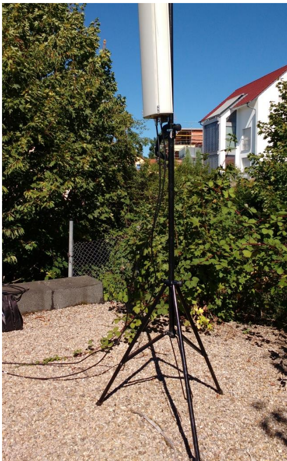
Abbildung 3: A) Standort IZAR RDC Premium mit Richtantenne X-Pol (Höhe 4 m)
