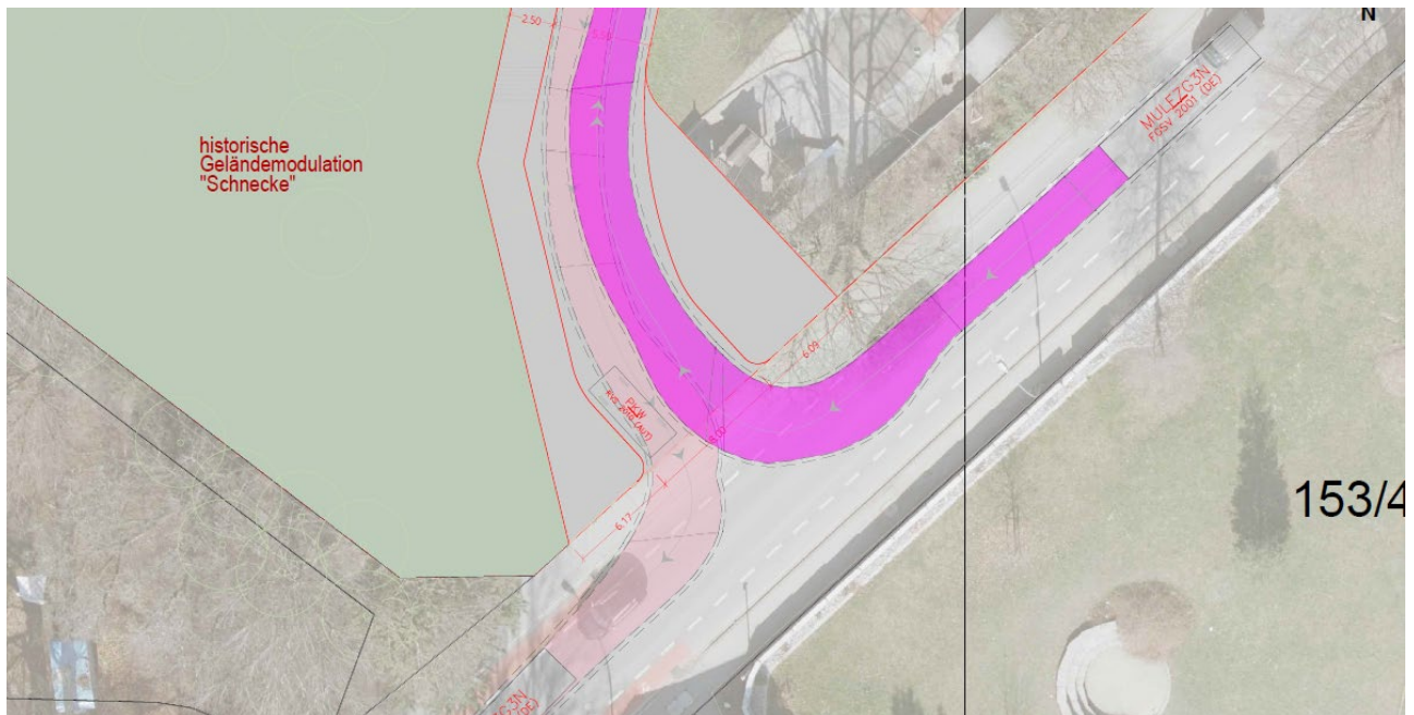
Abb. 8: Schleppkurvenprüfungen für Müllfahrzeug mit PKW-Begegnung, Anbindung 2 (BuP)
