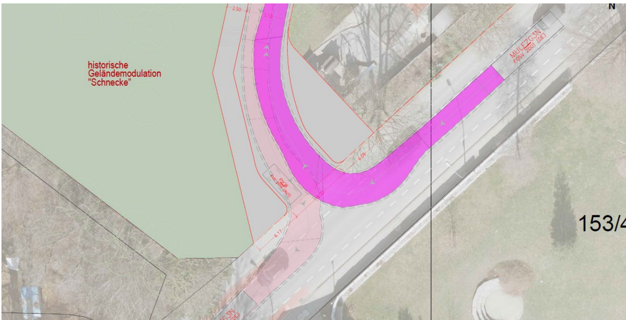
Abb. 8: Schleppkurvenprüfungen für Müllfahrzeug mit PKW-Begegnung, Anbindung 2 (BuP)
