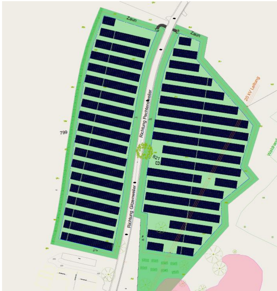
Abbildung 2: Belegungsplan der geplanten PVA - Quelle: Auftraggeber
