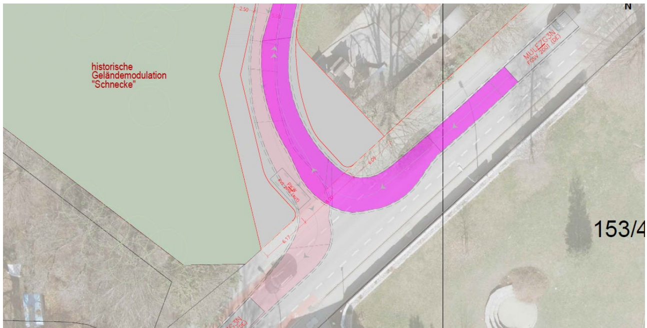
Abb. 8: Schleppkurvenprüfungen für Müllfahrzeug mit PKW-Begegnung, Anbindung 2 (BuP)
