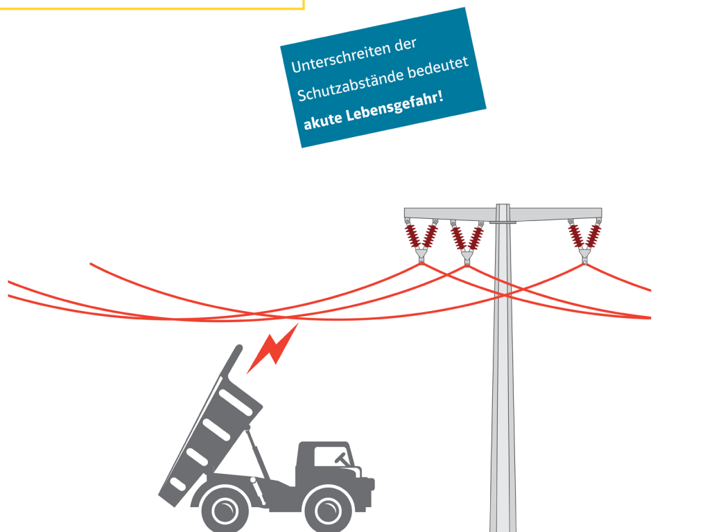
Abbildung 4: Berühren einer 20 kV-Leitung beim Entleeren eines LKW
