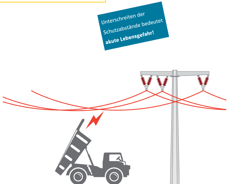
Abbildung 4: Berühren einer 20 kV-Leitung beim Entleeren eines LKW
