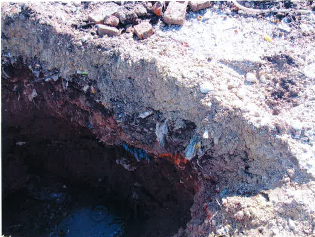
Abbildung 2: Beispielhaft für die örtlichen Bodenverhältnisse ein Blick in Baggerschurf SCH3 mit unauffälligen kiesigen Auffüllungen über abfallartigen Ablagerungen mit hohen Glas-, Kunststoff- und Metallanteil über bindigen Sedimenten. Grundwasser tritt regelmäßig in ca. 1,5-2 m Tiefe auf.
