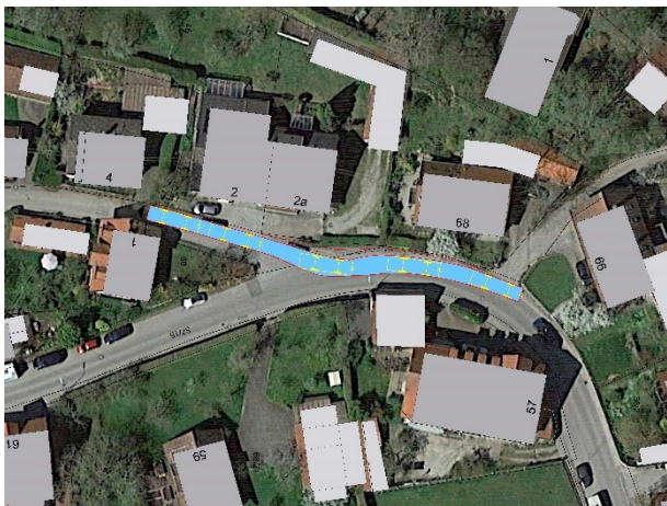
Schleppkurve Feuerwehr mit Restbreite Fahrbahn von 2,40 bis 2,60 m
