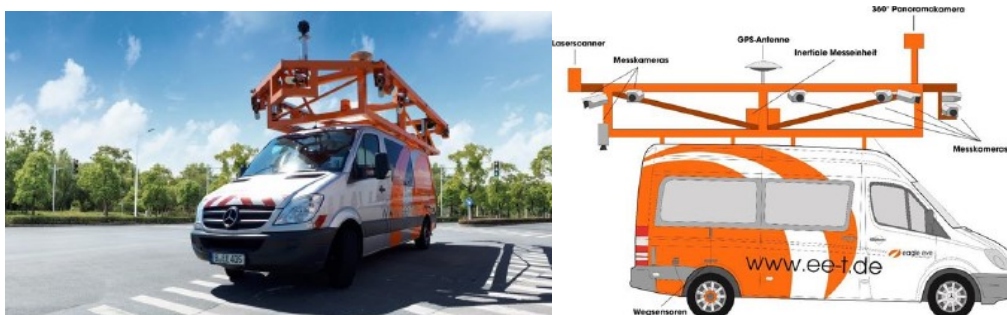
Abb.: Neues eagle eye-Fahrzeug bei der mobilen Datenerfassung (B-EE 405)
