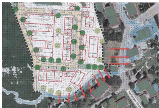
Rote Pfeile markieren anzunehmende Wasserflüsse durch Sickerwasser
