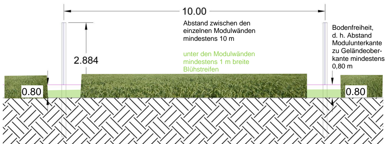
Abbildung: Schnitt durch die Modulreihen – Abstand mind. 10 m von Mitte Modulwand bis Mitte Modulwand Quelle: E4R 01/24
